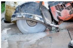
Machine avec système d'abattage à l'humide
