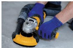
Machine équipée d'une aspiration
